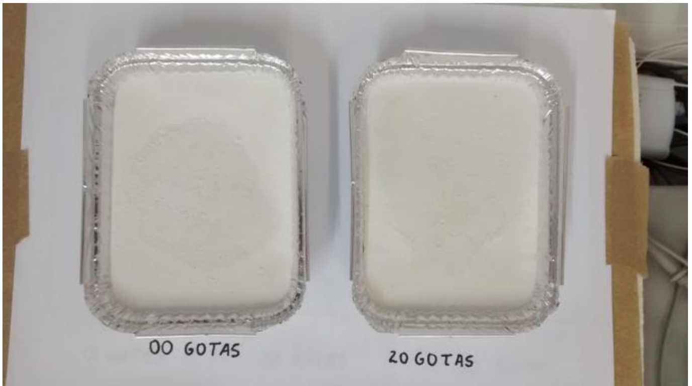
Figura 9 - Amostra de gesso com e sem indicador (24 horas).
