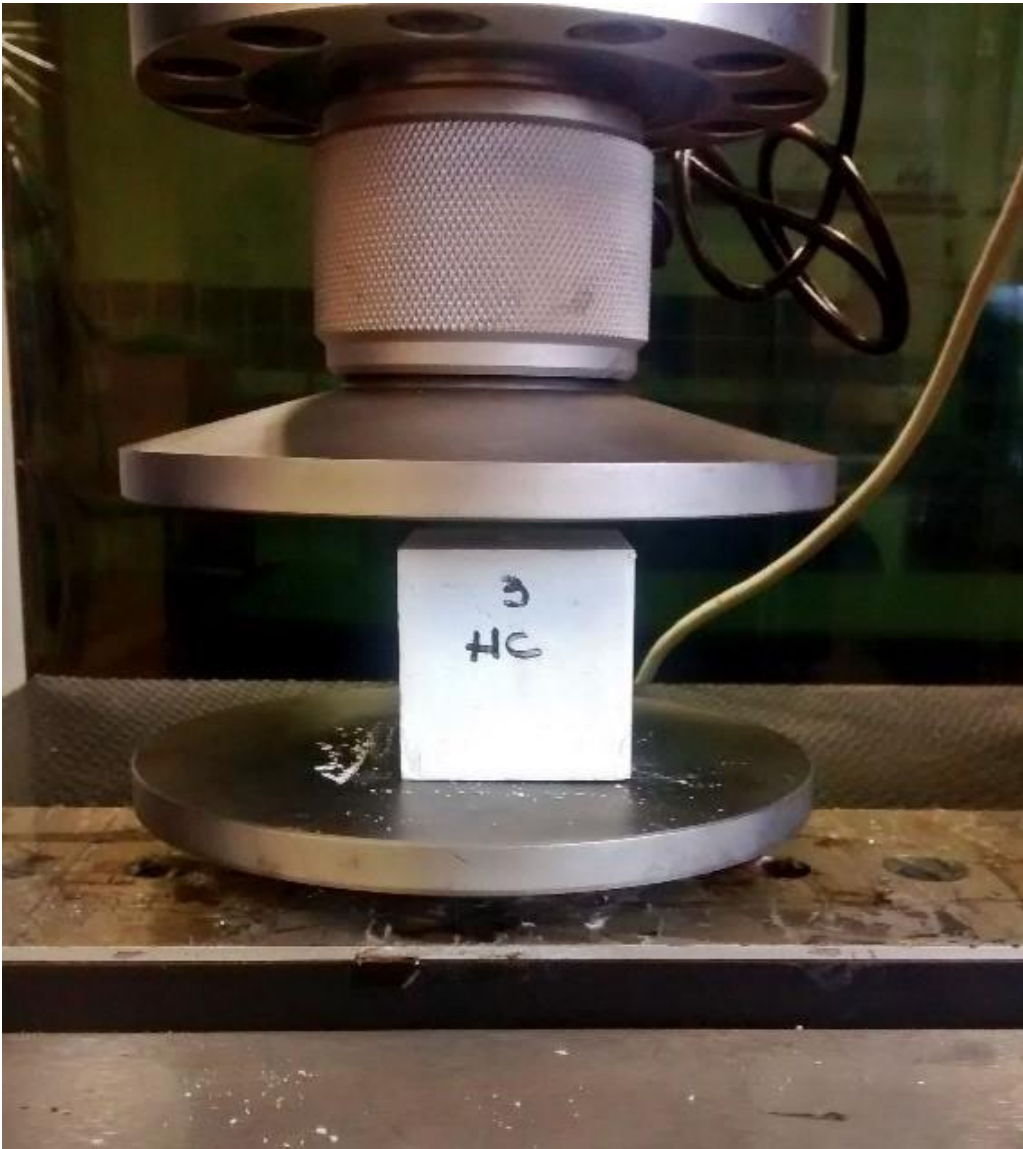
Figura 1 - a) Ensaio de dureza superficial e b) resistência à compressão Absorção de água por imersão total
