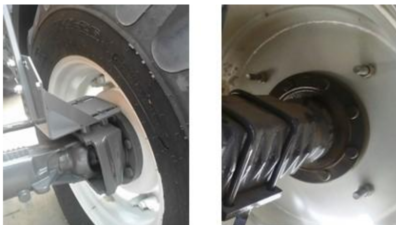
FIGURA 06 - Estrutura interna das rodas dianteira (a) e traseira (b) do trator.
