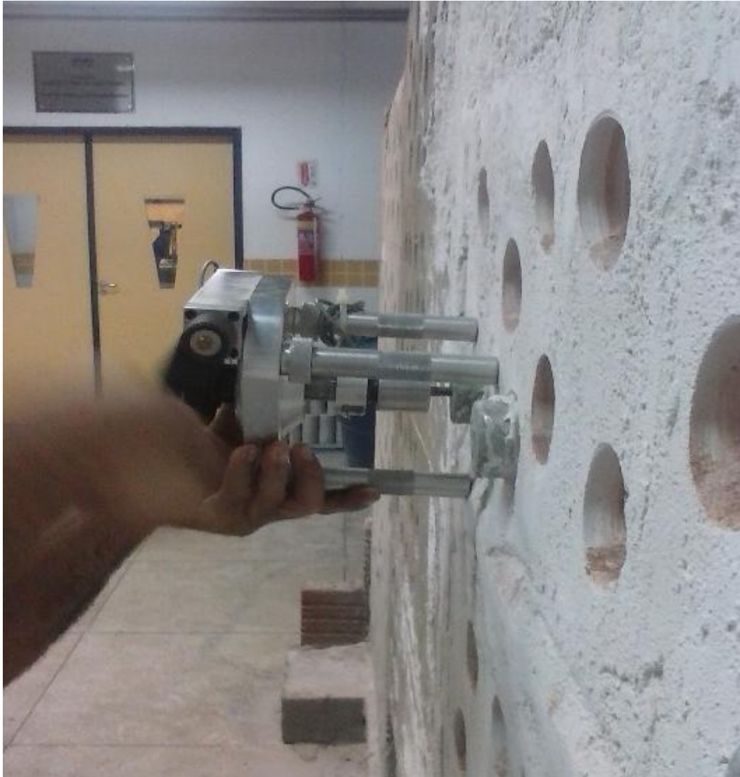
Figura 2 - Ruptura dos corpos de prova
